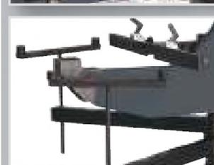
Поворотные опорные рычаги, регулируемые по высоте, каждый с двумя резиновыми подложками (опция)
