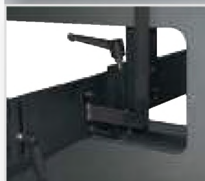
Ограничительная система с перемещением по оси Y с двумя направляющими, расположенными в корпусе пресса
