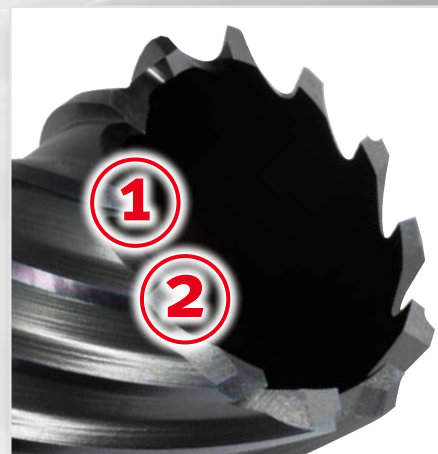
Высокоэффективная система чередования зубьев с черновым (1) и отделочным (2) резцом
