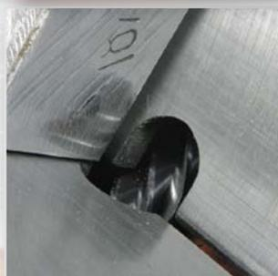
Точная настройка глубины/ширины фрезерования
