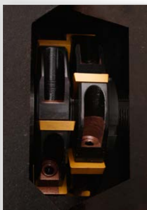
2 дисковые фрезы по 6 режущих пластин
