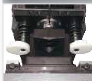
Фиксатор штампа с защитой от проворачивания в поршневом штоке, комбинация прижим/сбрасыватель
