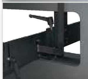
Ограничительная система с перемещением по оси Y с двумя направляющими, расположенными в корпусе пресса
