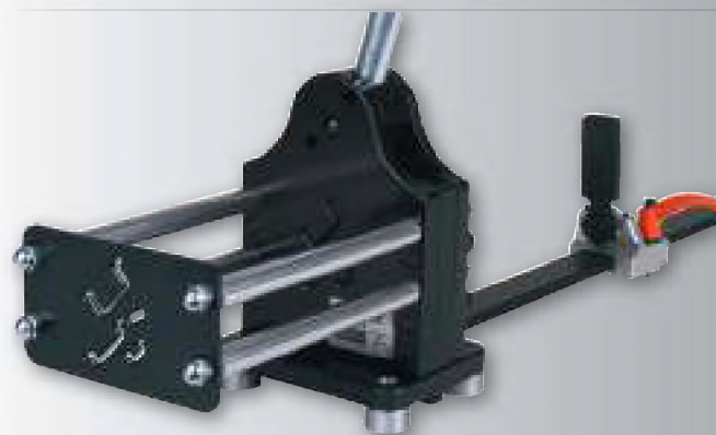
Направляющее устройство для точной резки под углом 90°
