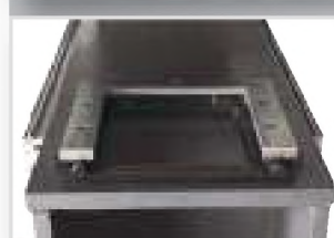
Фиксатор для матриц, возможна смена инструмента даже при заложенной в пресс двери распределительного шкафа
