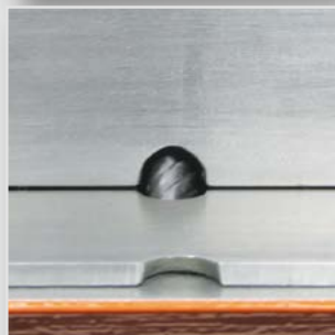
Положение II: толщина материала от 1,0 мм
