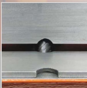
Положение I: толщина материала 6 – 14 мм
