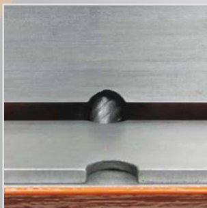
Положение I: толщина материала от 4,5 мм
