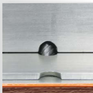
Положение II: толщина материала от 1,5 мм
