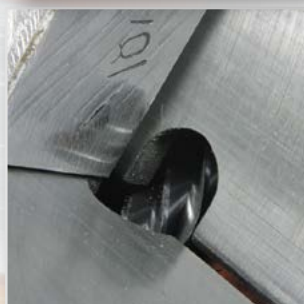
Точная снятие фаски за счет направляющих
